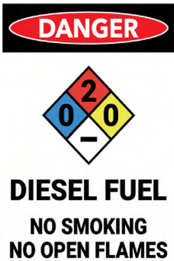
8 DIESEL FUEL GENERATOR SIGNAGE N.T.S.
